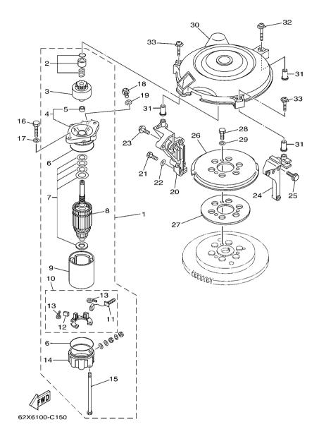
FIG. 15 STARTING MOTOR
