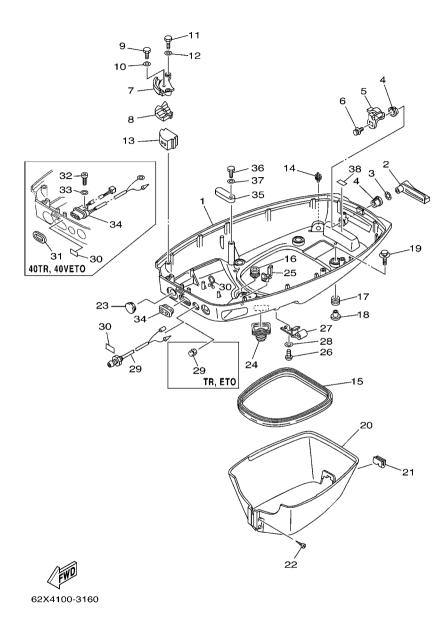
FIG. 16 BOTTOM COWLING
