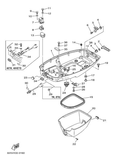
FIG. 16 BOTTOM COWLING
