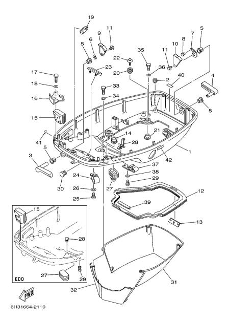
FIG. 11 BOTTOM COWLING
