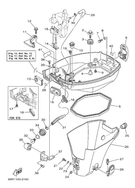
FIG. 15 BOTTOM COWLING
